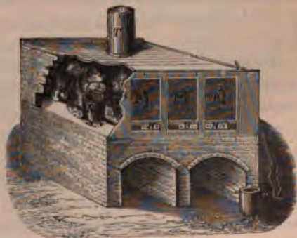
Fig. 81. — Four pour la combustion du soufre destiné à la fabrication de l'acide sulfurique. On voit par la cassure la marmite à nitre.
